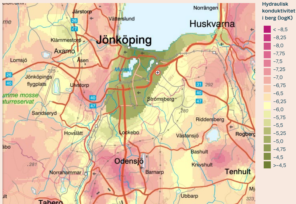
FIGUR 24 Utdrag ur kartvisaren "Hydraulisk konduktivitet i berg", där den mer genomsläppliga sandstenen under Jönköpings tätort framträder tydligt mot det mer täta och mindre vattenförande urberget runt omkring.
